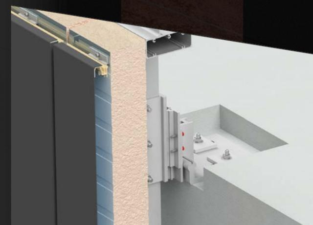
Les modules préfabriqués Speedwall s'étendent d'un plancher à l'autre et d'une colonne à l'autre, et se renferment conjointement, formant une façade complète résistante aux facteurs climatiques.
